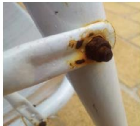
En esta silla, la oxidación se concentró en el punto de unión
