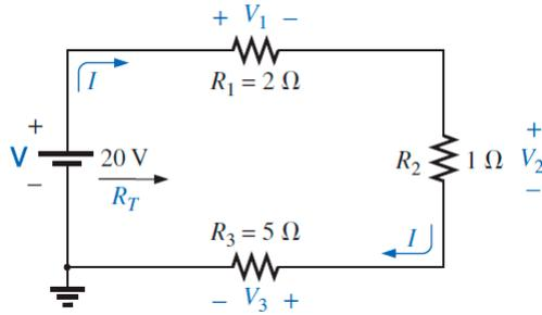
2. Determine la resistencia total ( $R_T$ ), la corriente del circuito ( $I$ ) y el voltaje en la resistencia dos ( $V_2$ ).
