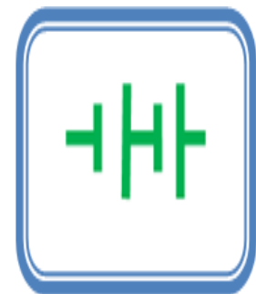
BATERIA DE ACUMULADORES
