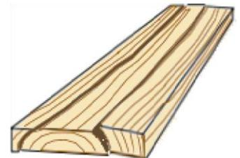
Las tablas de una madera con acebolladuras rajan durante el secado y sus fibras se separan en los anillos afectados.
