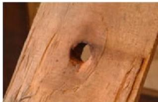
Los nudos son las bases de las ramas encerradas entre la madera del tronco. La madera de los nudos se destaca por su color más oscuro y tiene un sistema independiente de capas anuales. Estos nudos hacen difícil el trabajo de la madera, y son sueltos. Puede desprenderse dejando huecos.
